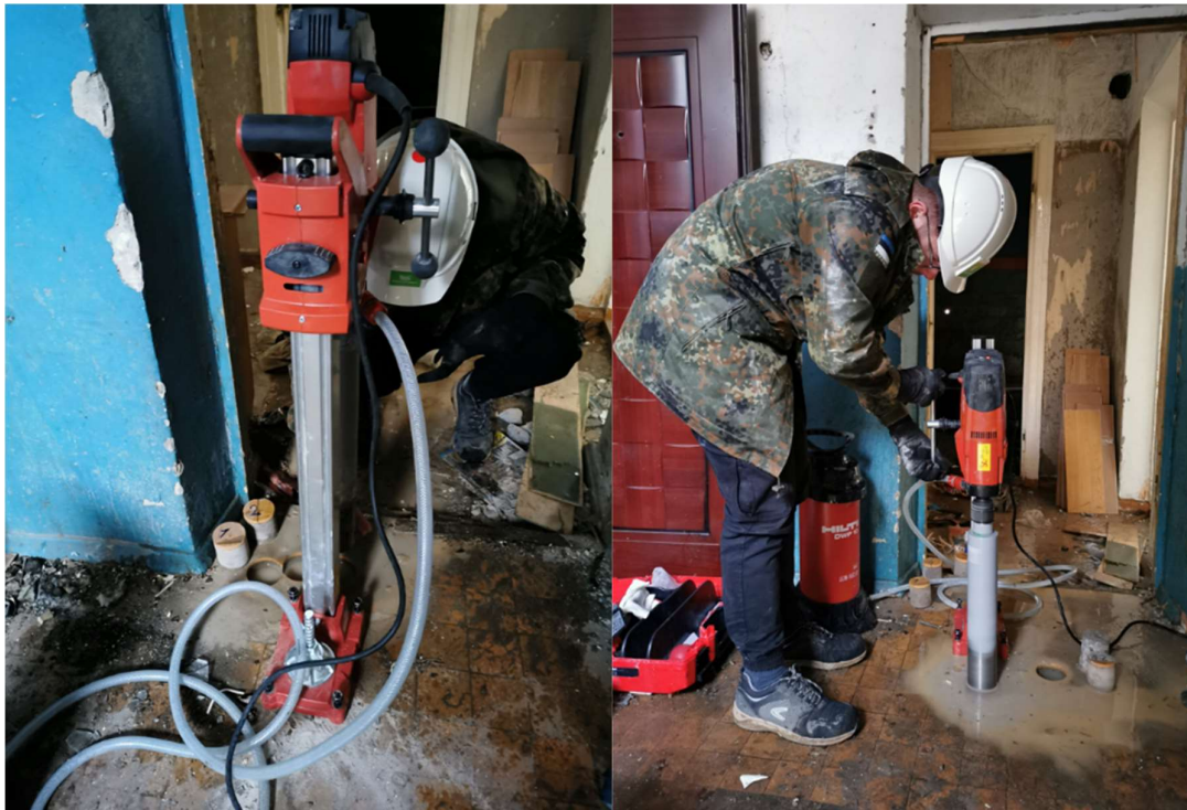
Foto 26. Teemantpuurimise komplekt Hilti fikseeritud Keskpuiestee 43 (Kiviõli) trepimademe külge (vasakul); betoonkatsekehade (kärnide) puurimine (paremal)
