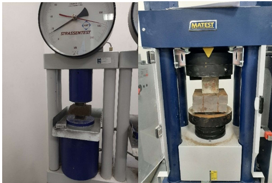
Foto 35. Kuivsegude katsetamine survele (katsekehad 7p. vanad)
