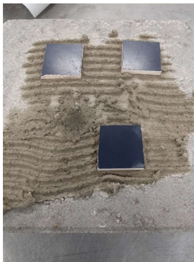
Foto 32. Kleepemördi kuivsegu nakketugevuse katsekeha
