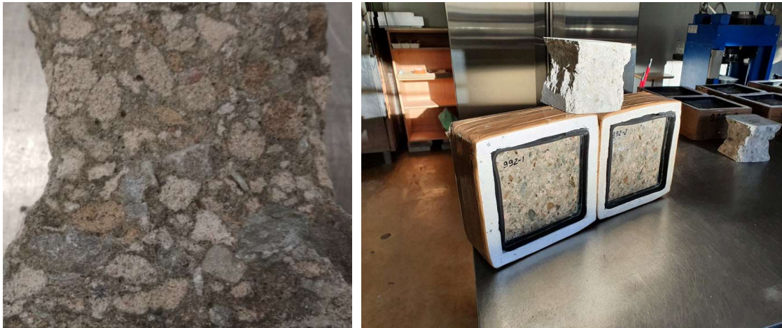
Foto 40. Fragment betoonkuubist pärast survetugevuskatset (vasakul) ning pärast külmakindluse katset (paremal).
