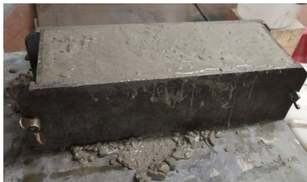
Foto 38. Vormitud ja tihendatud betoonisegu
