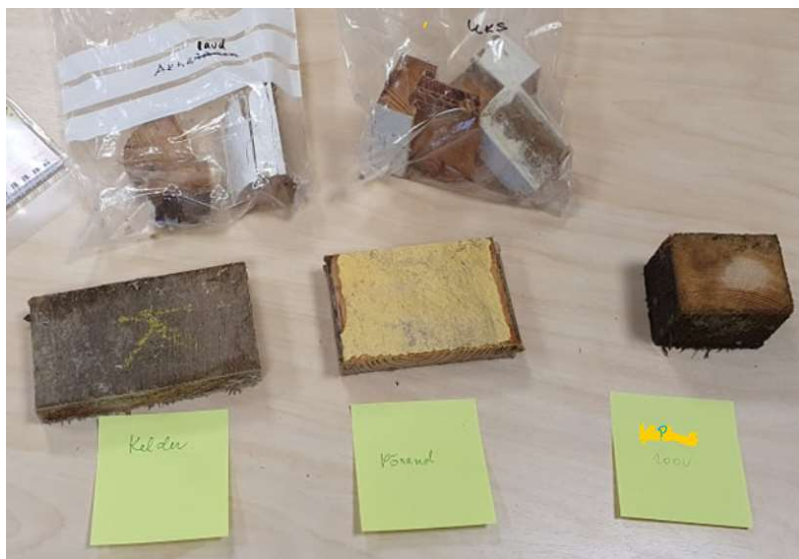
Foto 41. Keskpuiestee 43 hoonest võetud 5 puidutükki halogeenorgaaniliste ühendite ning raskmetallide sisalduse määramiseks
