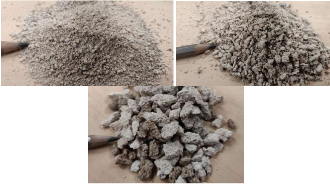
Foto 31. Kuivsegude retseptides kasutatud purustatud ja fraktsioonidesse sõelutud silikaatkivi. Fraktsioon 0,2mm (vasakul üleval); fraktsioon 0-4mm (paremal üleval); fraktsioon 4-8mm (all). Jämedama fraktsiooni puhul on näha heledamad (silikaatkivi) ning tumedamad (tsementmört) tükid.
