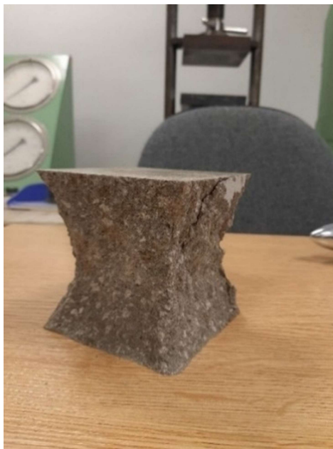
Foto 36. Betooni kuivsegust katsekeha purunemispilt
