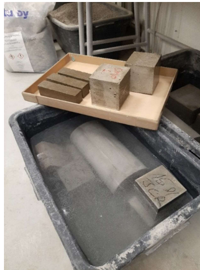
Foto 34. Kivinenud kuivsegude katsekehad
