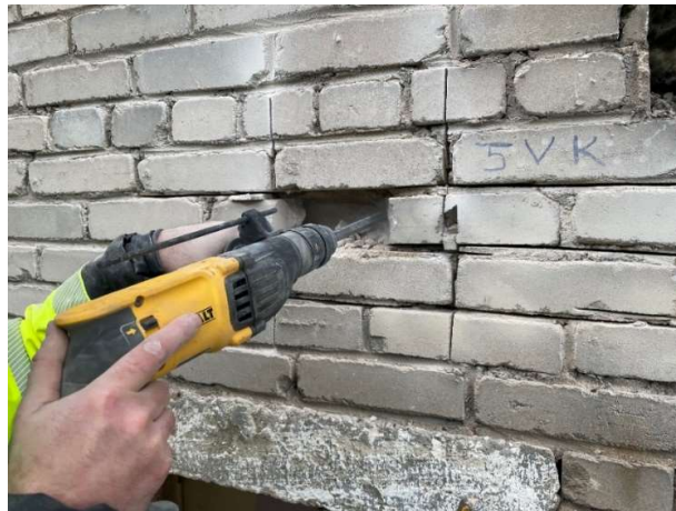
Foto 29. Katsekeha 5VK võtmine objektilt (08.11.2021)
