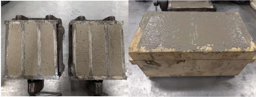
Foto 33. Kleepemördi kuivsegu katsekehad (vasakul), betooni kuivsegu katsekehad (paremal)
