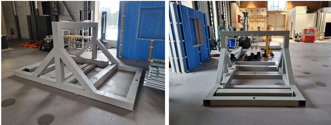
Foto 42. Tallinna Tehnikaülikooli Ehituskonstruksioonide katselaboratooriumi mobiilne raam, mis on üheks võimaluseks paneelide kandevõime testimiseks Keskpuiestee 43 objektil
